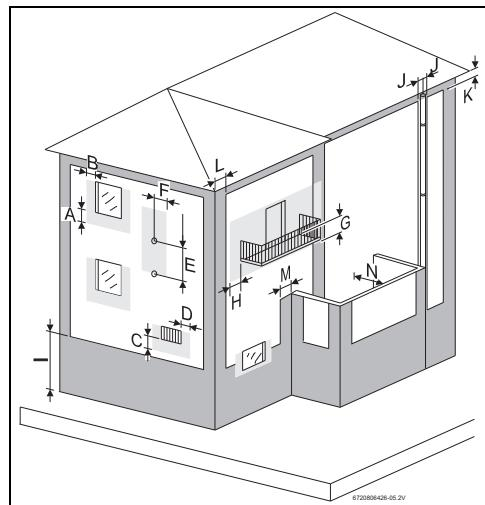
Рис. 13 Минимальные расстояния до труб отвода дымовых газов
