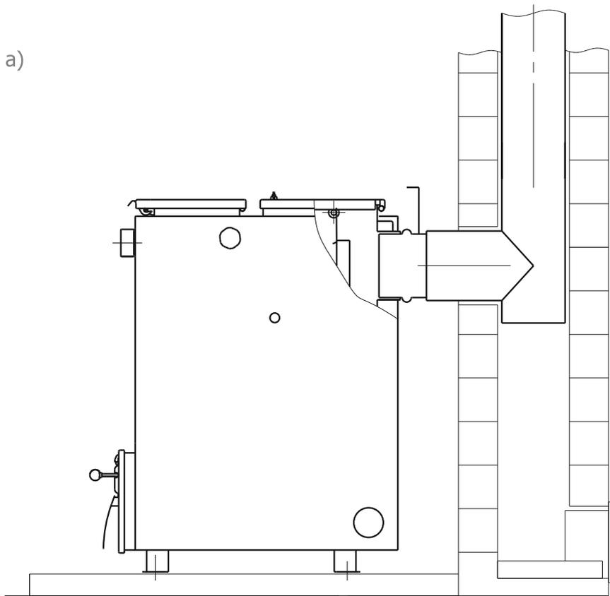
**Рис.6а** - Рекомендуемые схемы подключения котла к системе дымоотведения
