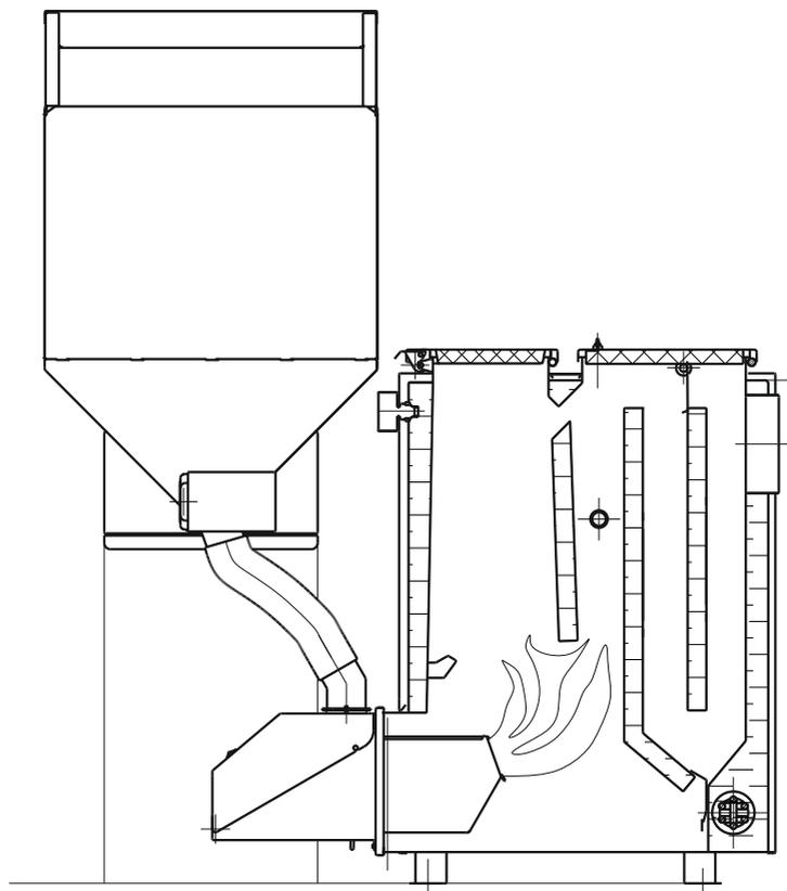
**Рис.4** - Установка опции - пеллетной горелки АПГ-40 на котел
