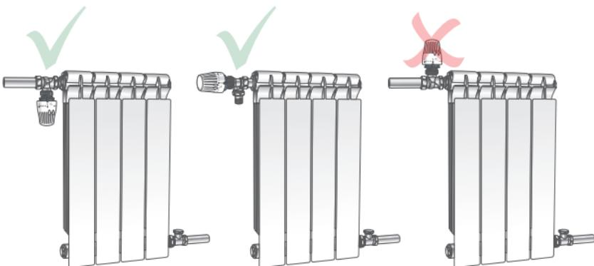
Убедитесь, что имеется достаточно места для установки, обслуживания и движения воздуха. Для более корректной работы термостатический элемент головки должен находиться на достаточном расстоянии от источников тепла (горячий трубопровод, горячий воздушный поток и т.п.).
